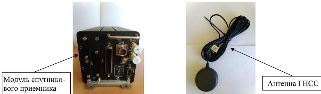
Рисунок 1 – Общий вид комплекса
