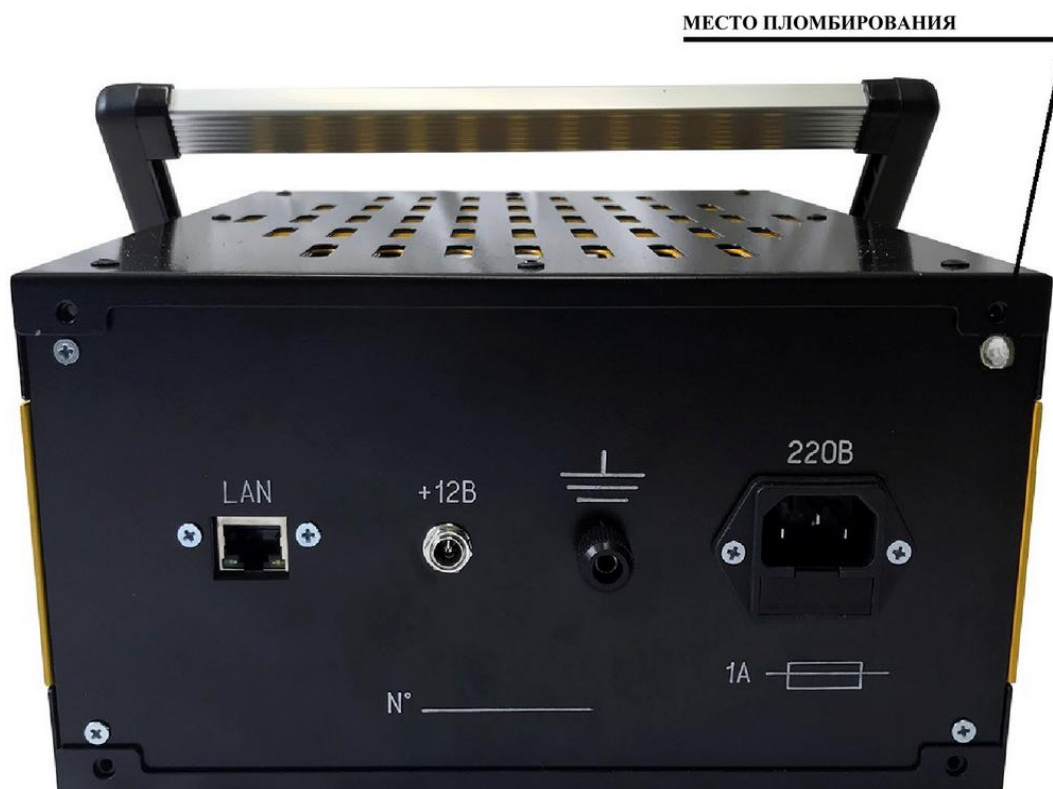
Рисунок 2 – Схема пломбирования блока измерительного от несанкционированного доступа
