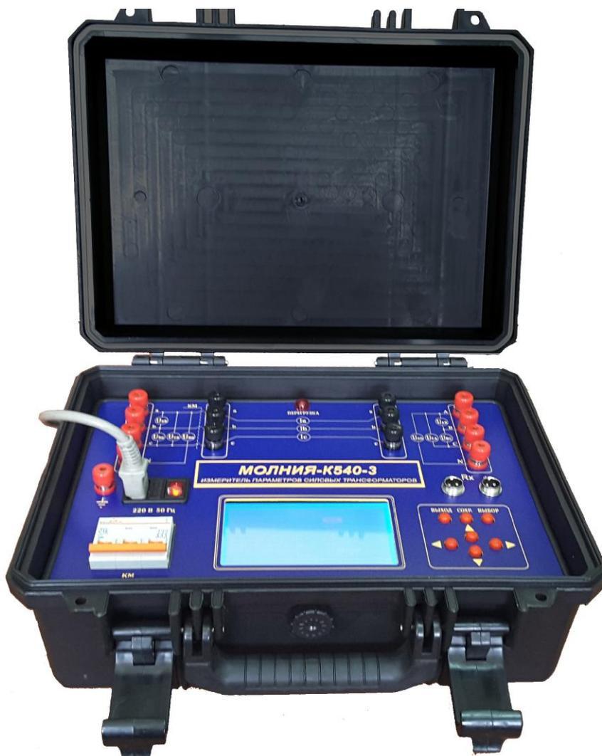
Рисунок 1 – Общий вид измерителей параметров силовых трансформаторов МОЛНИЯ-К540-3
