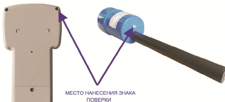
Рисунок 2 – Место нанесения знака поверки
