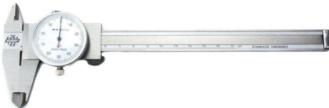
Рисунок 2 – Общий вид штангенциркулей типа ШЦК-I
