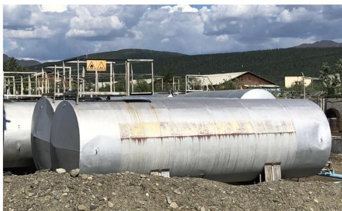
Рисунок 2 - Общий вид резервуаров стальных горизонтальных цилиндрических РГС-60
