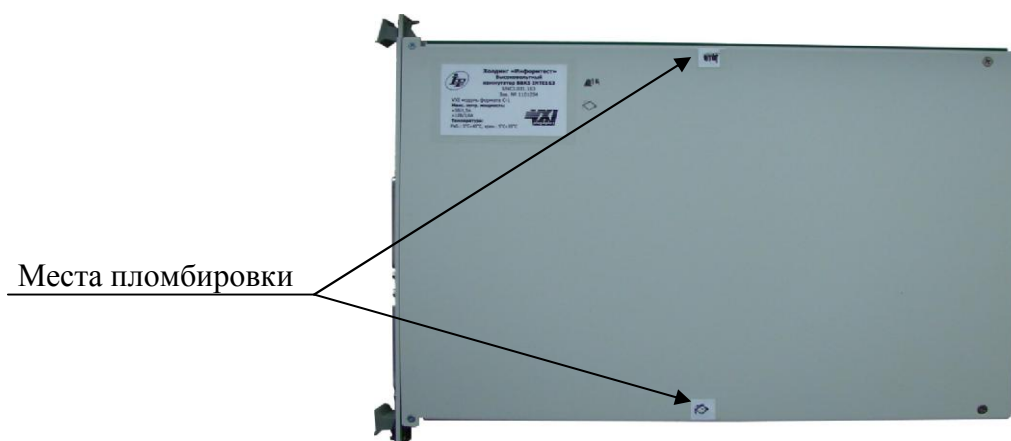
Рисунок 2 – Схема пломбировки от несанкционированного доступа функционального модуля системы
