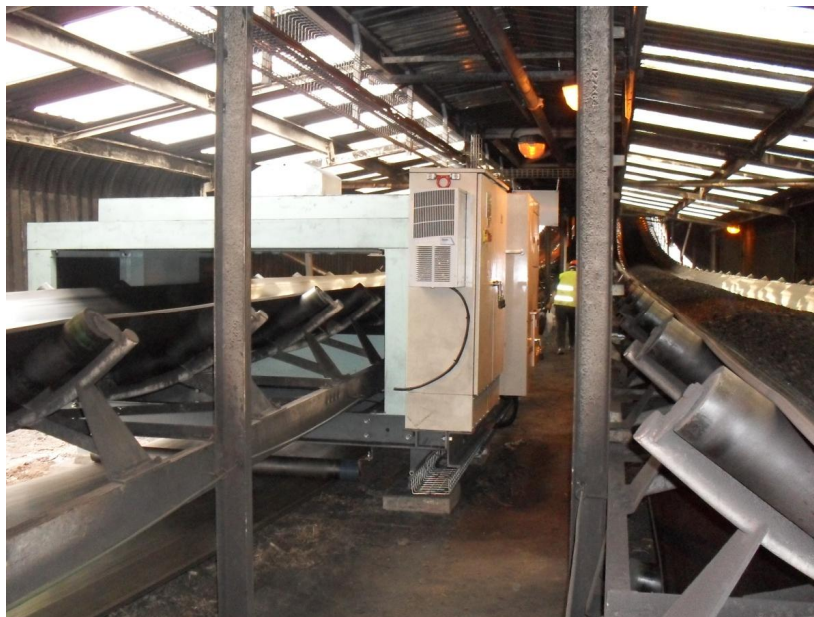
Рисунок 1 – Общий вид анализатора элементного состава радиоизотопного НИТА II
