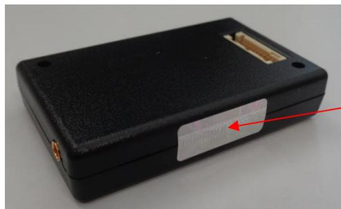
Место пломбировки от несанкционированного доступа
