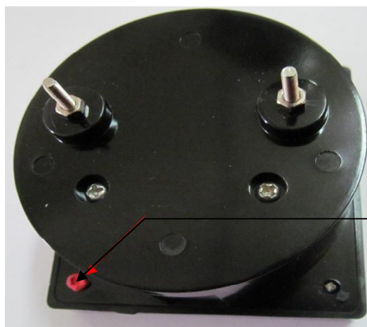
Рисунок 4 – Вид задней стороны приборов с местом нанесения знака поверки на пломбу
