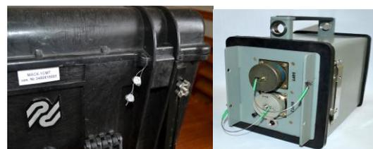
Рисунок 7 – Пломбы на ящике МАСК-1СМТ и блоке СМ-М1
