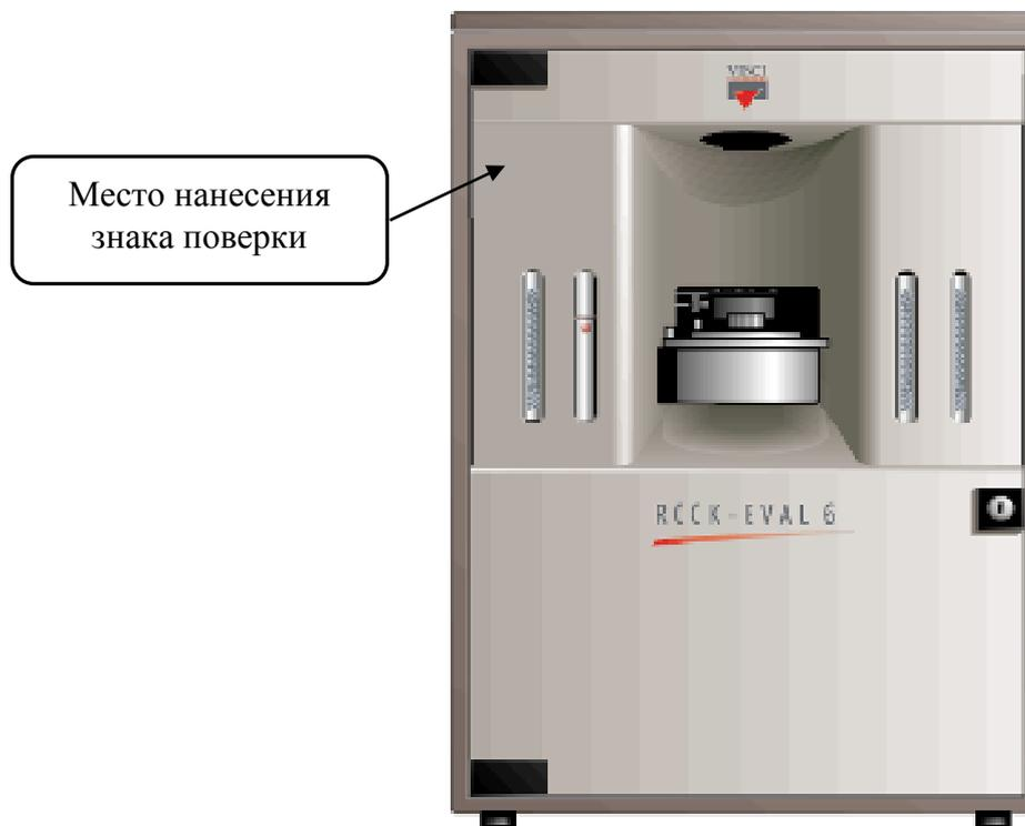
Рисунок 1 – Общий вид анализаторов горных пород Rock-Eval 6
