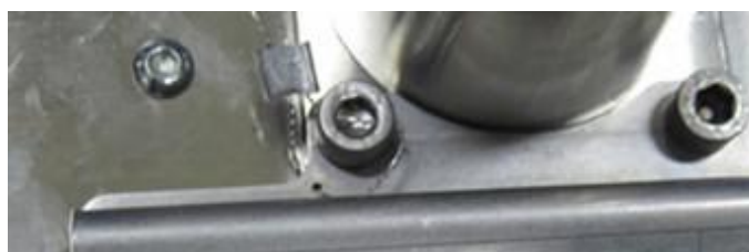
Рисунок 2а – Пломбировка основной маркировочной таблички пломбой завода-изготовителя
