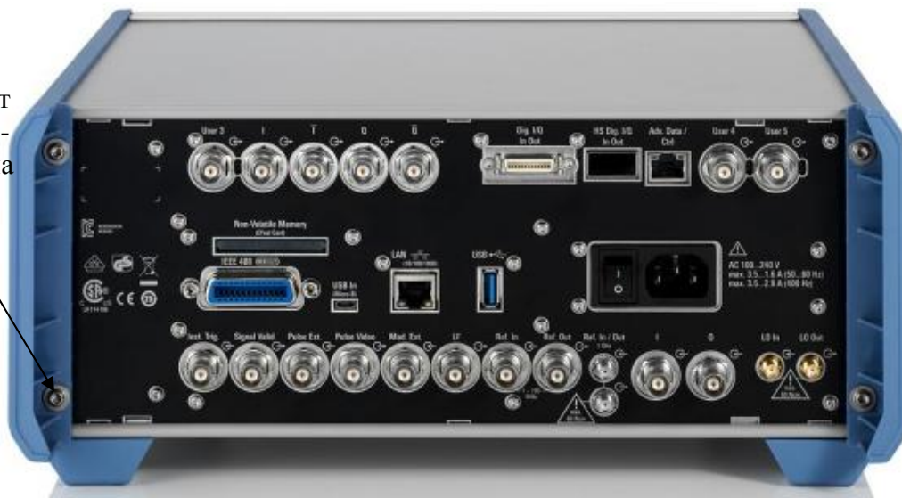
Рисунок 2 - Схема пломбировки от несанкционированного доступа
