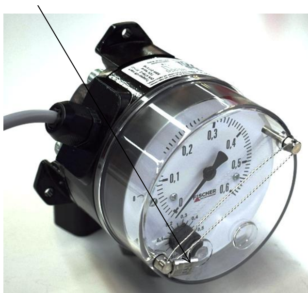
Рисунок 2 — Схема пломбировки манометров от несанкционированного доступа
