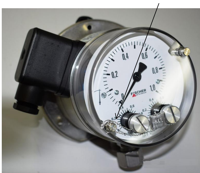
Рисунок 2 — Схема пломбировки манометров от несанкционированного доступа
