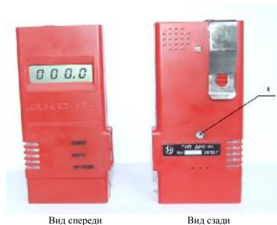
Рисунок 1 – Общий вид дозиметра ДКС-04
