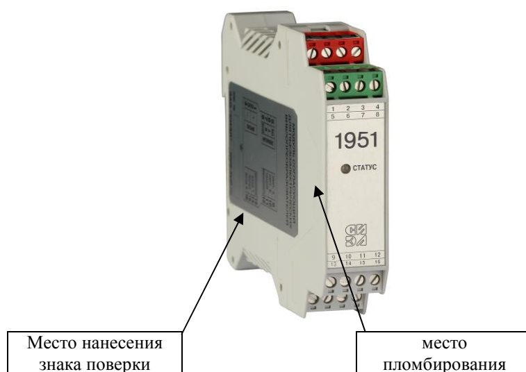
Рисунок 1 – Внешний вид модуля СИЭЛ–1951
