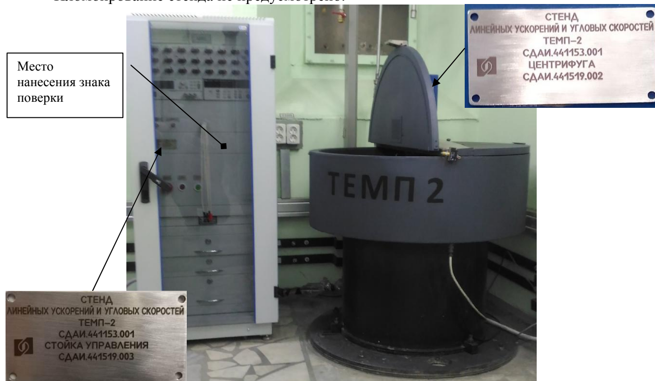
Рисунок 1 - Общий вид центрифуги и стойки управления стенда ТЕМП-2
