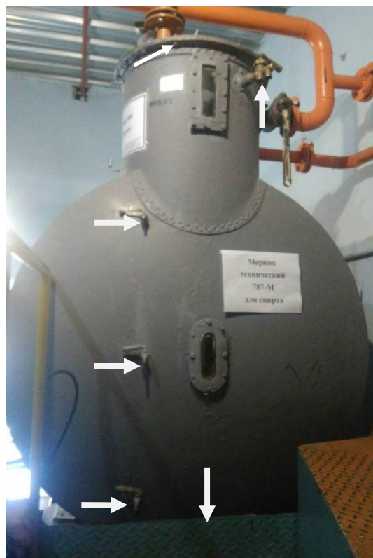
Рисунок 2б - Схема пломбировки мерников 787-М зав.№№ 1, 2, 6, 7 от несанкционированного доступа
