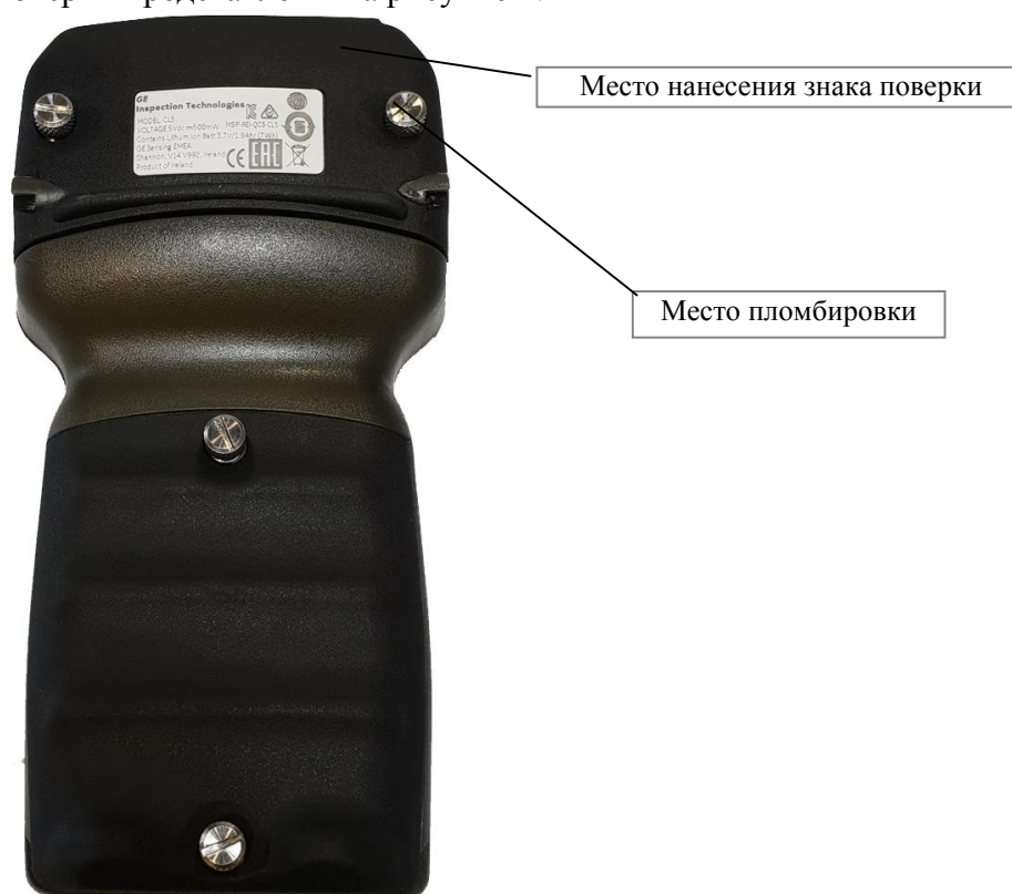
Рисунок 2 – Схема пломбировки от несанкционированного доступа
