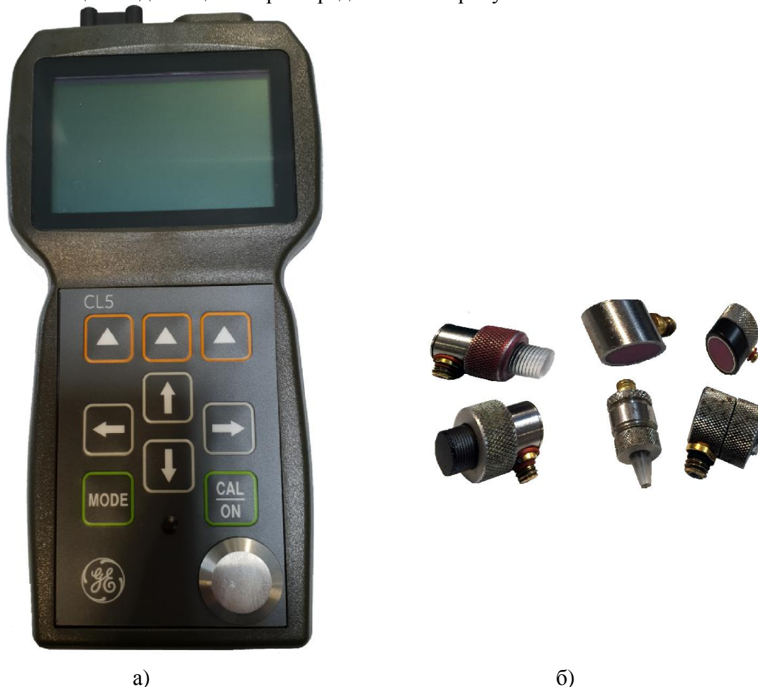
Рисунок 1 – Общий вид толщиномеров а) электронный блок, б) преобразователи ультразвуковые
