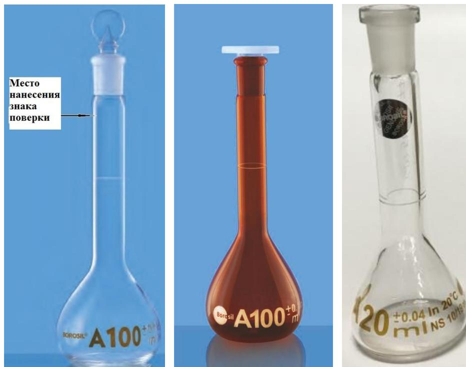
Рисунок 1 - Общий вид колб мерных класса точности А
