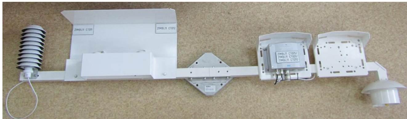
Рисунок 1 – Общий вид прибора комбинированного для измерений температуры окружающей среды НМТ337, установленного на монтажном каркасе
