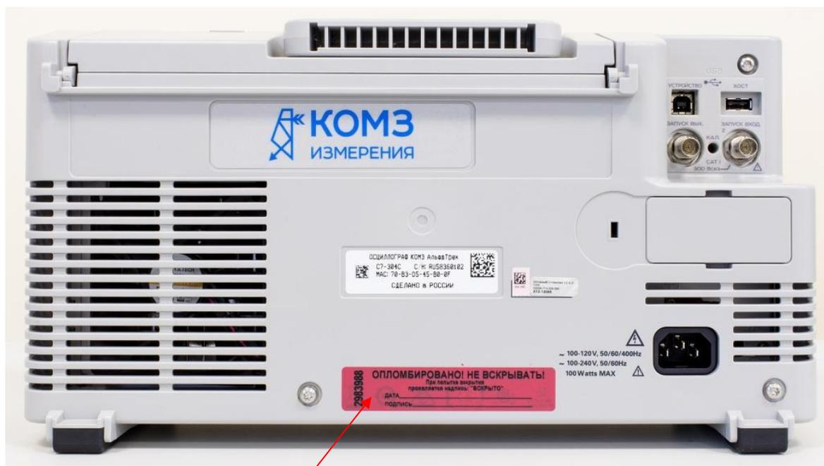
Схема пломбирования (стикер-наклейка)
