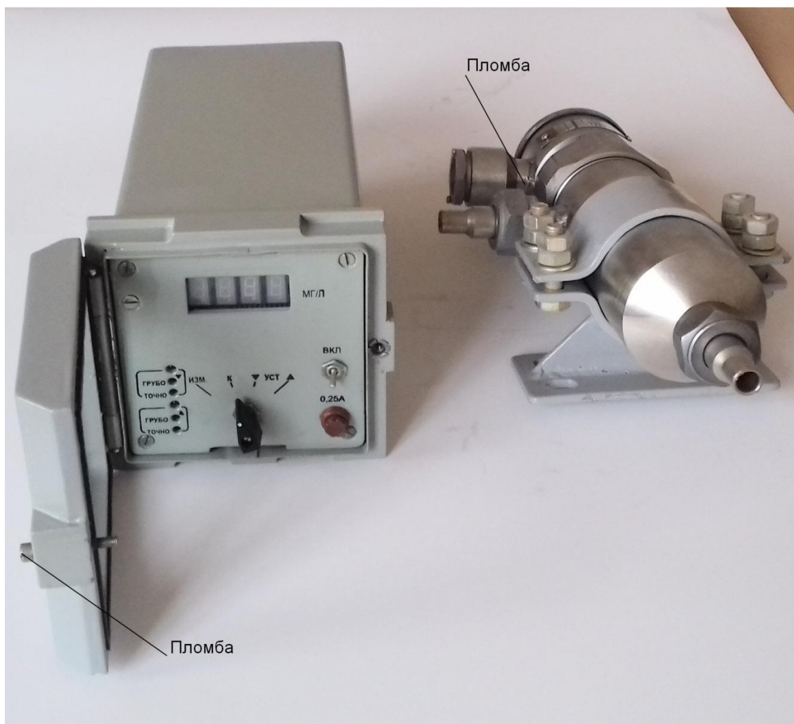
Рисунок 1 - Общий вид солемера показывающего сигнализирующего типа «САМ01»
