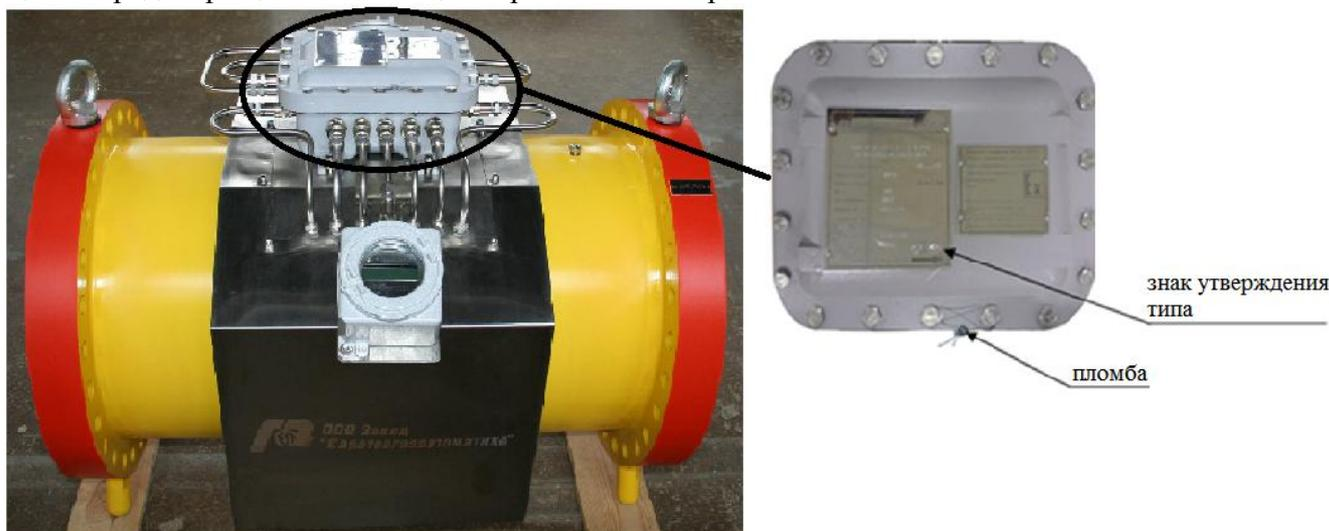
Рисунок 2 – Схема пломбирования расходомеров газа ультразвуковых MPU серии С
