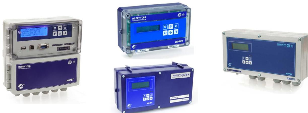
Рисунок 1 – Общий вид тепловычислителей ВЗЛЕТ ТСРВ
