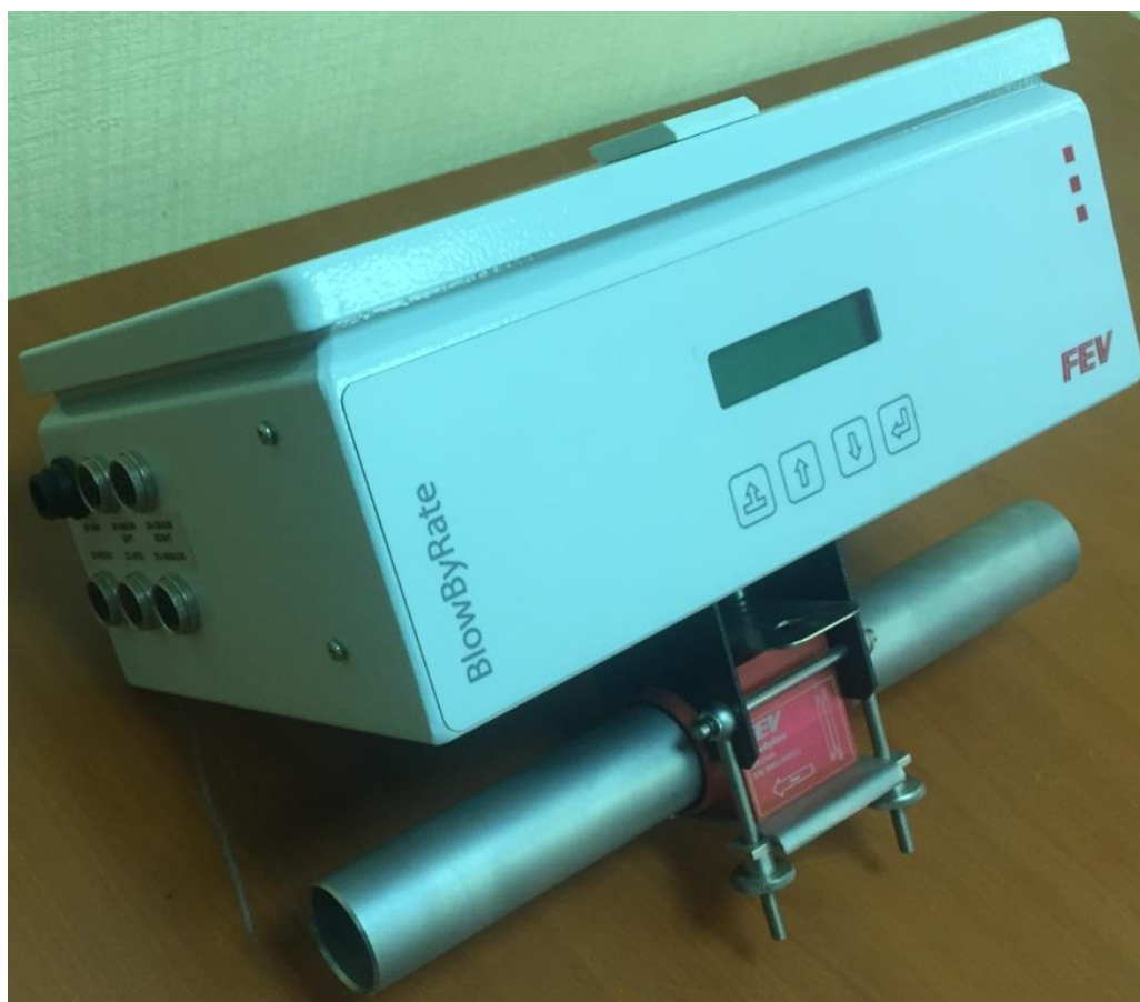
Рисунок 1 - Общий вид счетчика FEV BlowByRate
