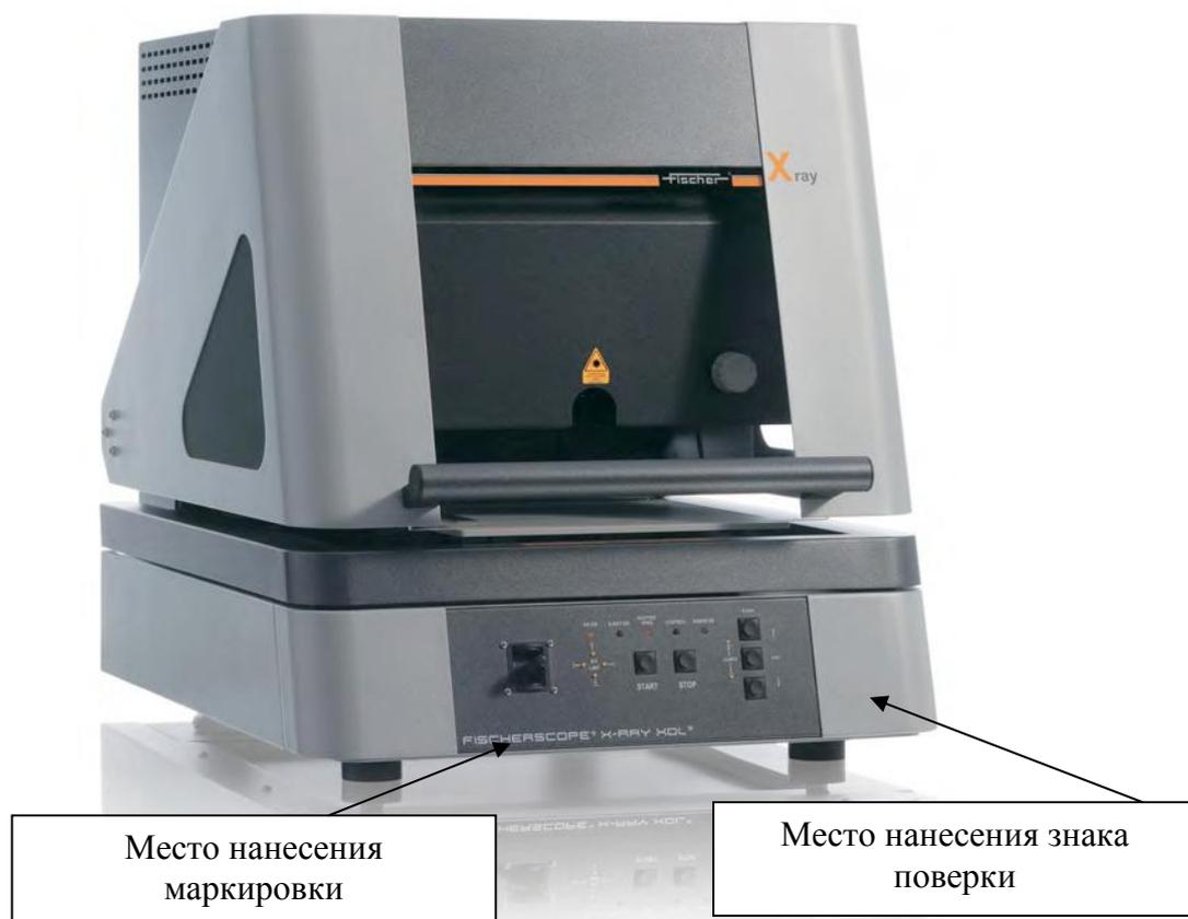
Рисунок 5 – Общий вид Спектрометров-толщиномеров рентгенофлуоресцентных FISCHERSCOPE X-RAY моделей XDL 210, XDL 220, XDL 230, XDL 240
