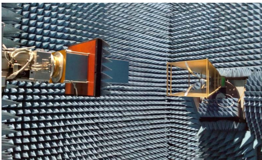
Рисунок 1 – Общий вид сканера с установленной антенной-зондом и ОПУ с установленной испытываемой антенной
