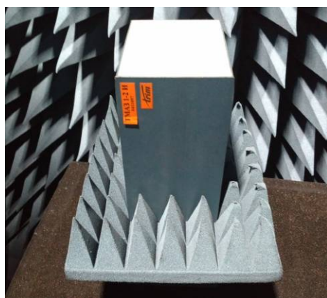
Рисунок 3 – Общий вид антенны-зонда ТМА3 1-2 И и ТМА3 2-4 И
