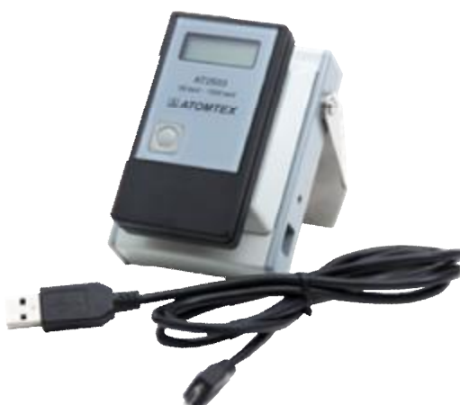
Рисунок 3 – Общий вид дозиметров совместно с устройством считывания
