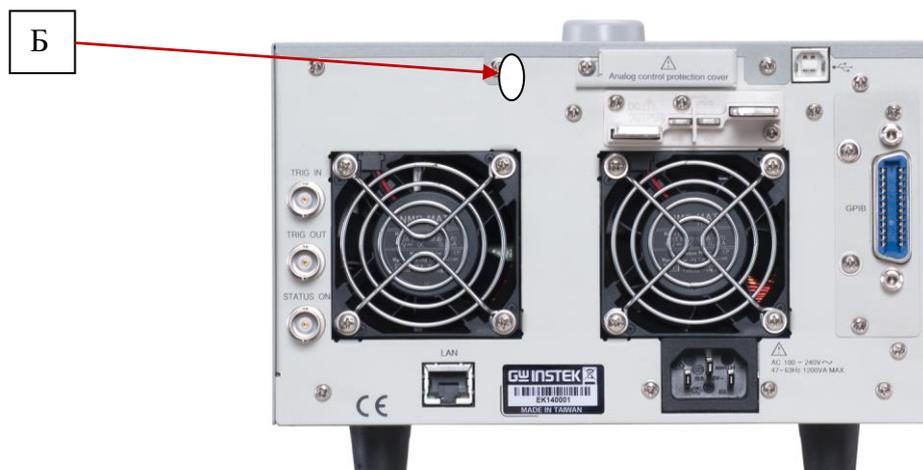
Рисунок 2 – Схема пломбировки от несанкционированного доступа (Б).
