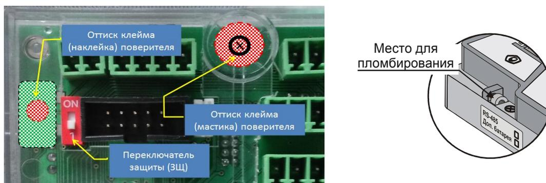
Рисунок 2 – Места пломбирования и нанесения знака поверки
