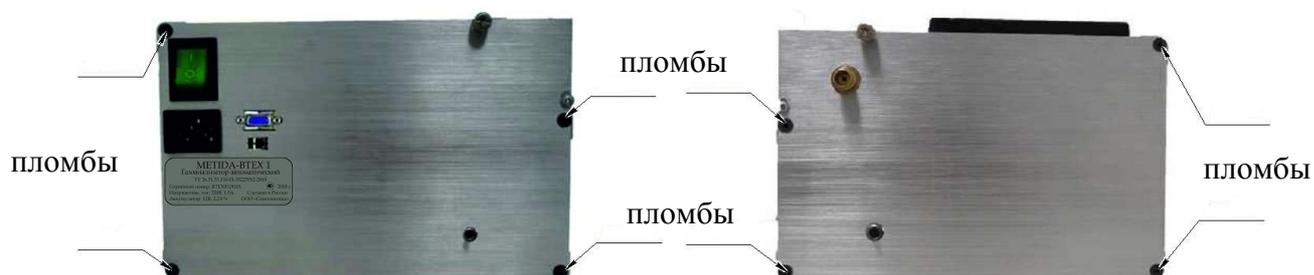
Рисунок 2 – Схема пломбировки от несанкционированного доступа
