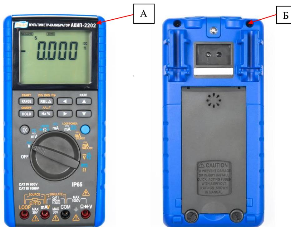
Рисунок 1 – Общий вид мультиметров, схема нанесения знака утверждения типа (А) и схема пломбировки от несанкционированного доступа (Б)
