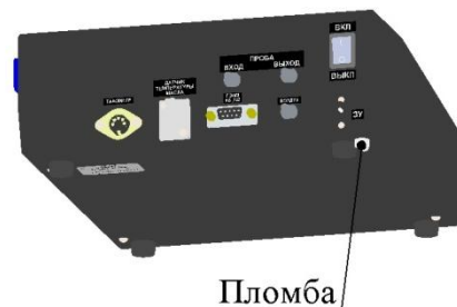
Рисунок 9 – Место пломбирования приборов АВТОСКАН-01.03МИНИ
