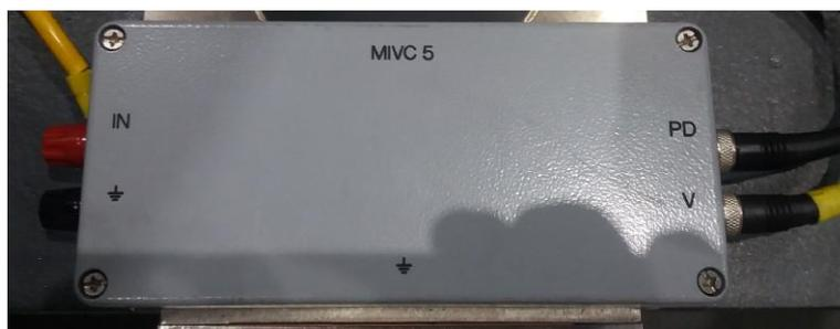
Рисунок 3 – Общий вид согласующего блока MIVC 5
