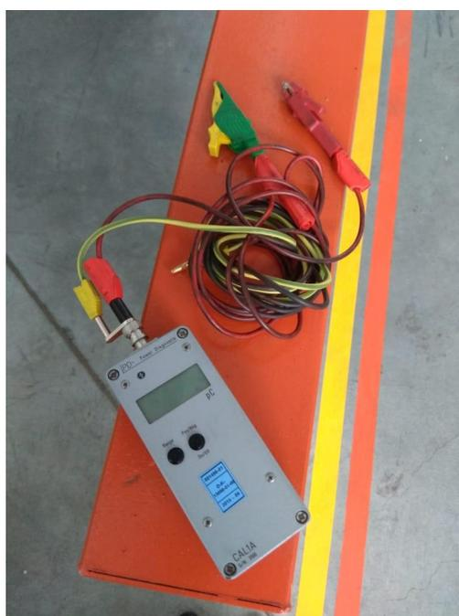
Рисунок 5– Общий вид калибратора кажущегося заряда CAL1A
