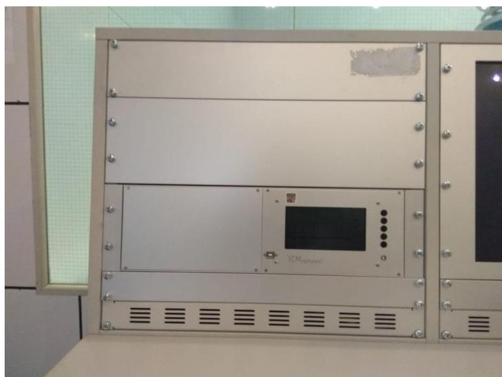
Рисунок 2 – Общий вид измерителя ICMcompact, смонтированного в стойку
