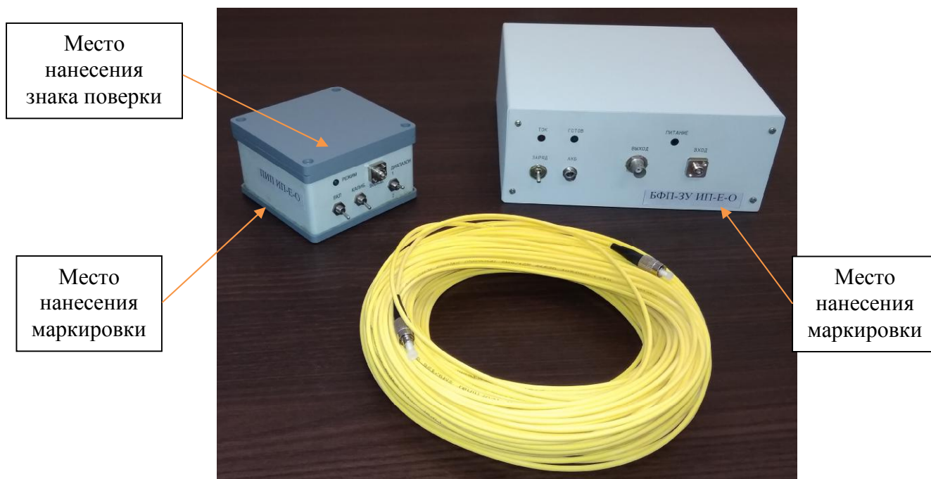
Рисунок 2 – Обозначение места нанесения маркировки, знака поверки
