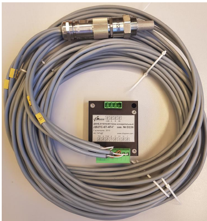
Рисунок 1 – Общий вид преобразователей влажности и температуры ДВ2
