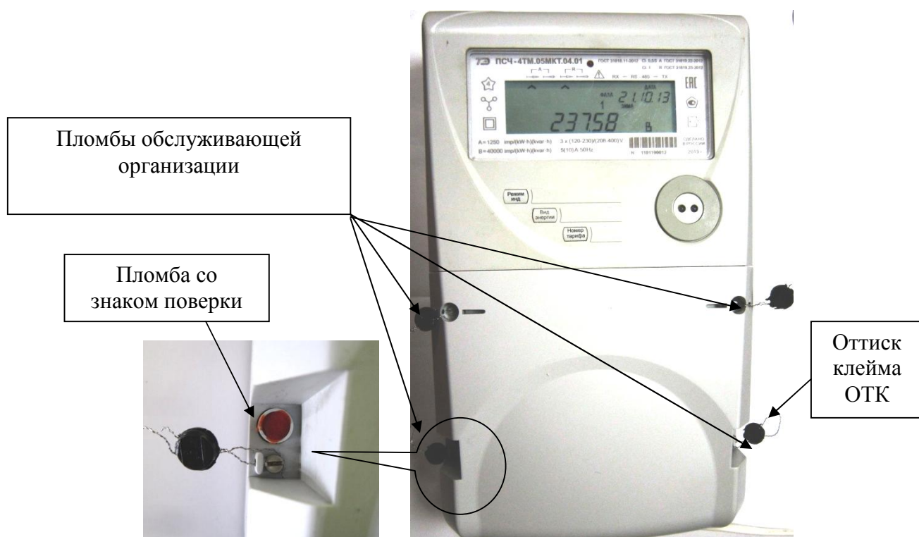
Рисунок 1 – Общий вид счетчика, схема пломбирования от несанкционированного доступа, обозначение места нанесения знака поверки
