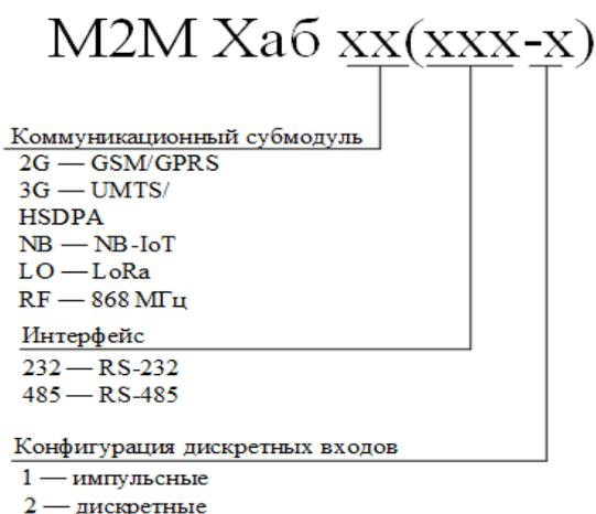
Рисунок 6 – Принцип формирования модификации УСПД M2M Хаб
