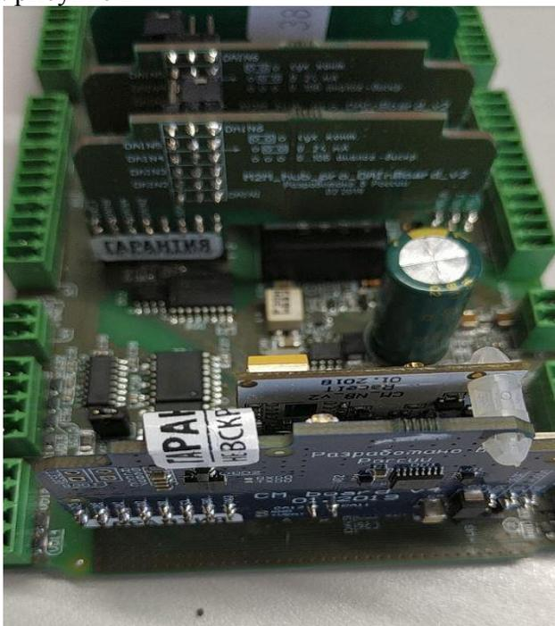
Рисунок 2 – Место установки защитной наклейки, блокирующей доступ к технологическому разъему для прошивки УСПД.
