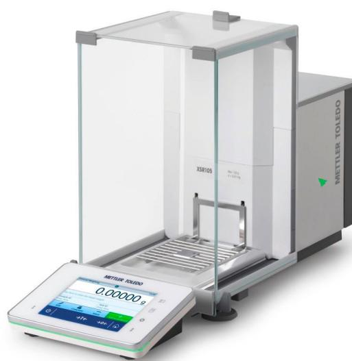
Рисунок 1г – Общий вид весов XSR105/A, XSR105DU/A, XSR205DU/A, XSR225DU/A, XSR64/A, XSR104/A, XSR204/A, XSR204DR/A, XSR304/A
