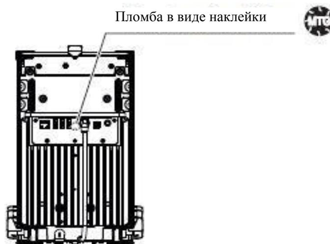
Рисунок 2а – Пломбировка взвешивающего модуля, вид сзади
