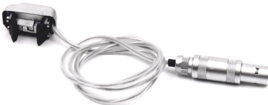
Рисунок 1 - Внешний вид датчиков перемещений (деформаций) ЕХА 10-0,5х, ЕХА 25-1,25х
