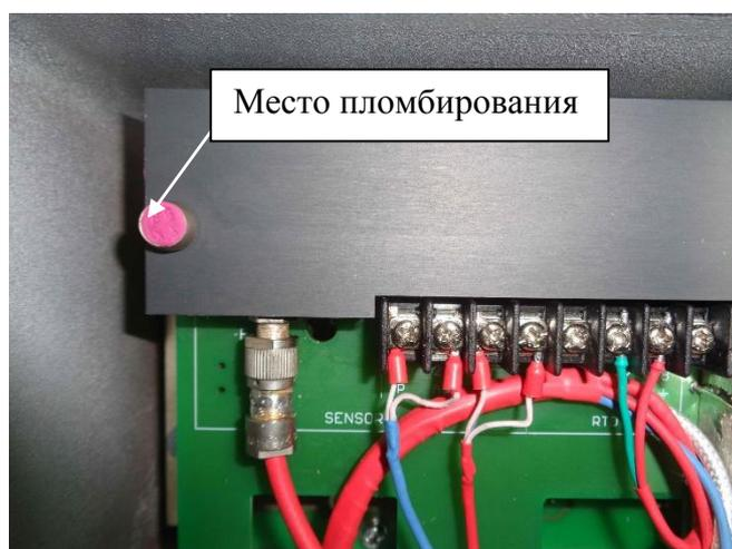
Рисунок 5 – Место пломбирования влагомера
