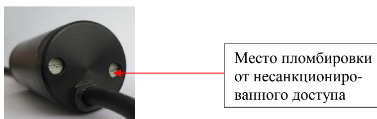
Рисунок 2 - Схема пломбировки от несанкционированного доступа
