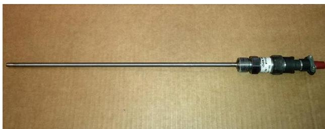
Рисунок 6 - Термопреобразователь сопротивления ТП-9201
