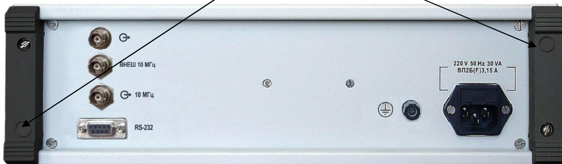
Рисунок 2 – Схема пломбировки от несанкционированного доступа, обозначение мест нанесения знака поверки
