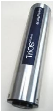
Рисунок 1 – Общий вид анализатора полиароматических углеводородов в воде enviroFlu-NC
