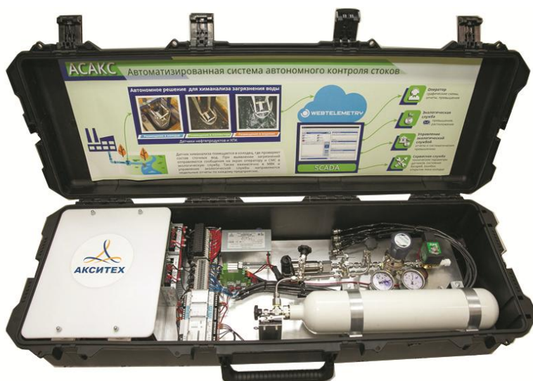
Рисунок 2 – Общий вид шкафа телеметрии
