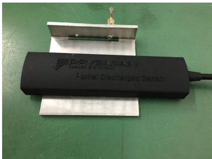
Рисунок 2 – Общий вид измерительных датчиков Pry-Cam Wings
