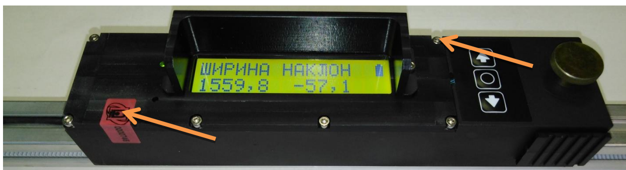
Рисунок 4 – Места пломбирования ШЭП (указаны стрелками)
