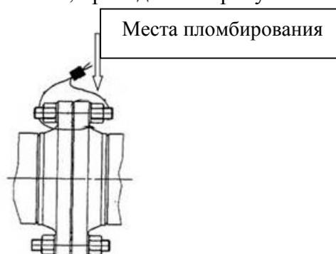
Рисунок 3 – Схема пломбировки от несанкционированного доступа, обозначение места нанесения знаков поверки на фланцевые соединения расходомеров массовых Promass, входящих в состав установки
